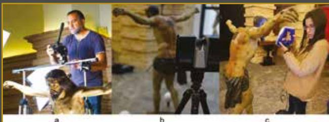
Proceso de adquisición masiva de datos del Cristo de la Sangre mediante fotogrametría, escaneado láser y de luz estructurada.
