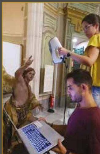
Digitalización del Ángel de la Oración del Huerto con escáner manual de luz estructurada.
