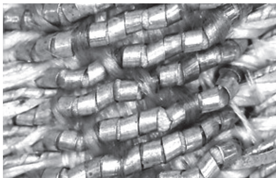
Fig. 2. Visión microscópica de la composición de hilos entorchados de oro. Fuente: Elaboración propia.
